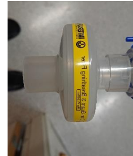
Figur 1 Andningsfilter som regionJH använder. Samtliga filter på bilderna är godkända för COVID-19. Fabrikat: Intersurgical. Det blåa barnfiltret ska endast användas på neonatalballongen, vuxenfilter på övriga
